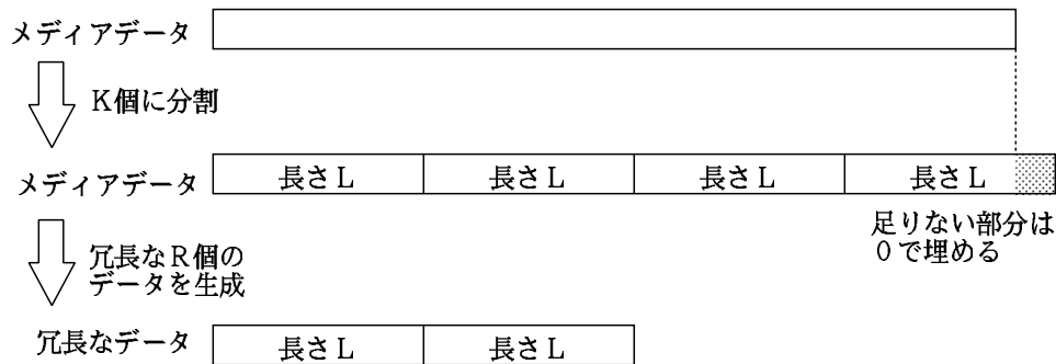
図 4: リードソロモン符号による冗長なパケットの生成
